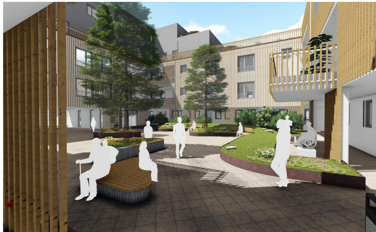
Senkrechte Holzlamellen verkleiden zum Teil die Fassaden und Laubgänge zum Innenhof.
